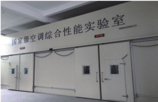
国家级 180kW 焓差实验室
